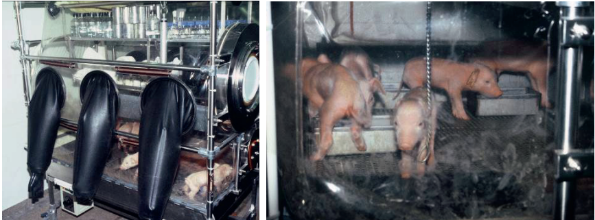
Abb. 23: Isolatoren zur Aufzucht keimfreier Ferkel.
